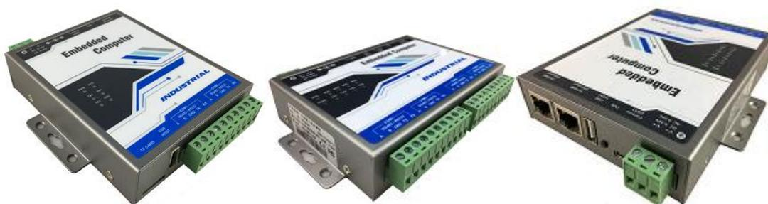
网关在应用现场通过接口和传感器、仪表、PLC 等设备连接，使用协议实时采集终端设备的运行数据，并把采集到的数据转换成 modbus RTU/TCP 的协议格式发送到其他设备或者云平台。
